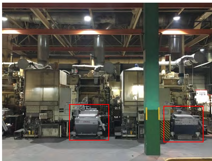
图3.2-6 现场保持炉照片
