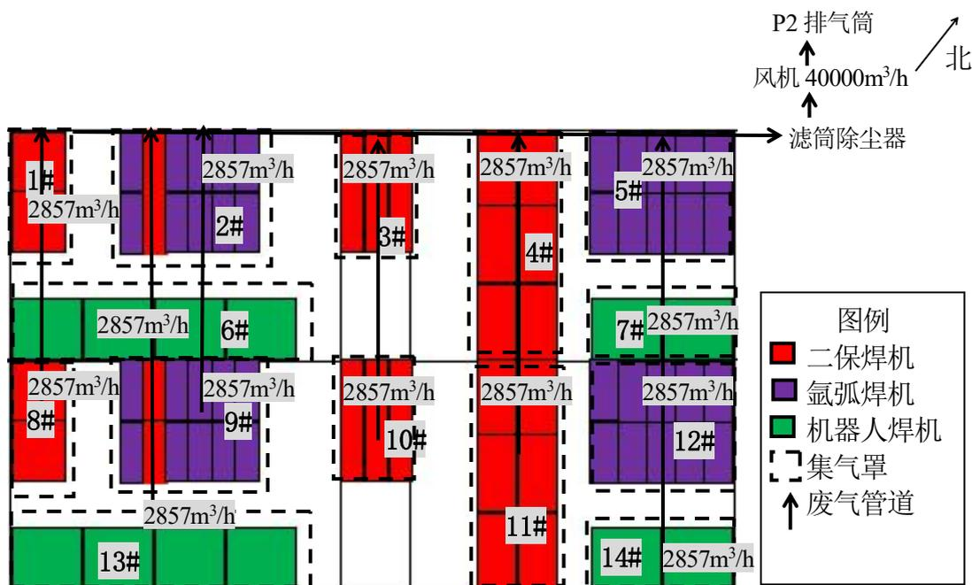
图 8 扩建车间废气管道路线示意图
